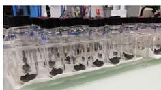
Détermination en laboratoire des propriétés de rétention des biochars sélectionnés
