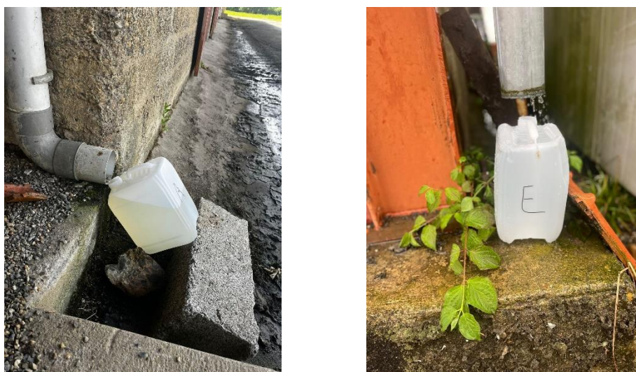
Figure 10 : Méthode artisanale de récupération des ERT.
