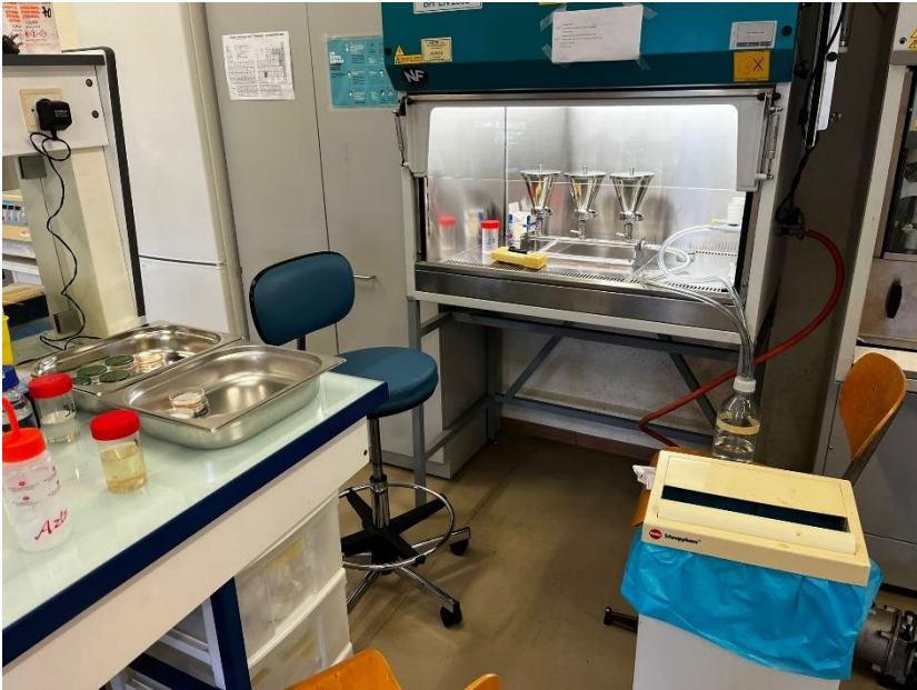
Figure 4 : Filtration des ERT sur membrane à l'aide d'une rampe stérile.
